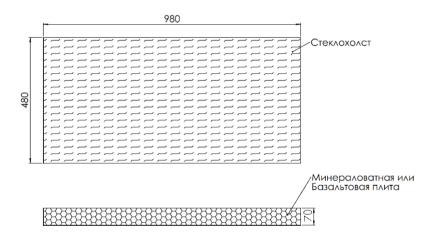
Рисунок 8 – кашированная минераловатная или базальтовая плита
