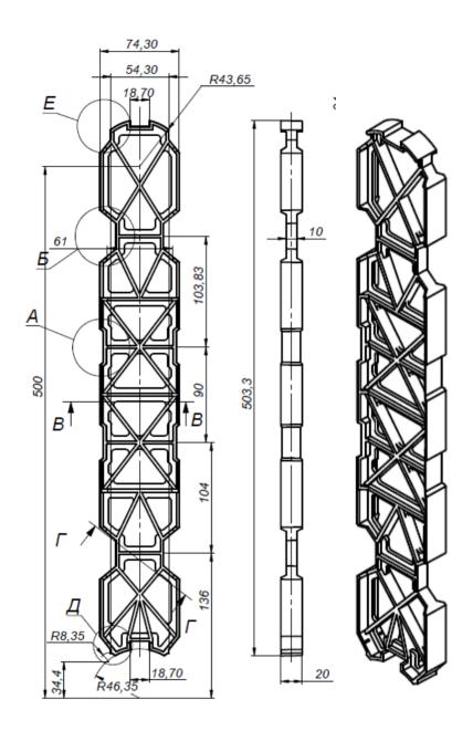
Рисунок 4 – Ребро жесткости
