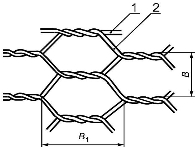
1 – проволока кромки; 2 – основная проволока; В – размер ячейки;
